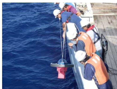
図 9. GPS 波浪ブイの投入光景。2007 年 8 月、(独)水産総合研究センター蒼鷹丸にて
