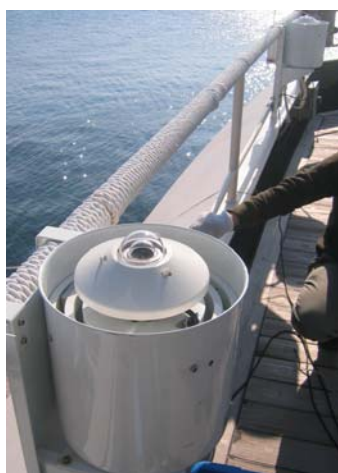
図3. 白鳳丸に搭載した日射計および赤外放射計（上）と清水校舎における検証実験結果（右）
