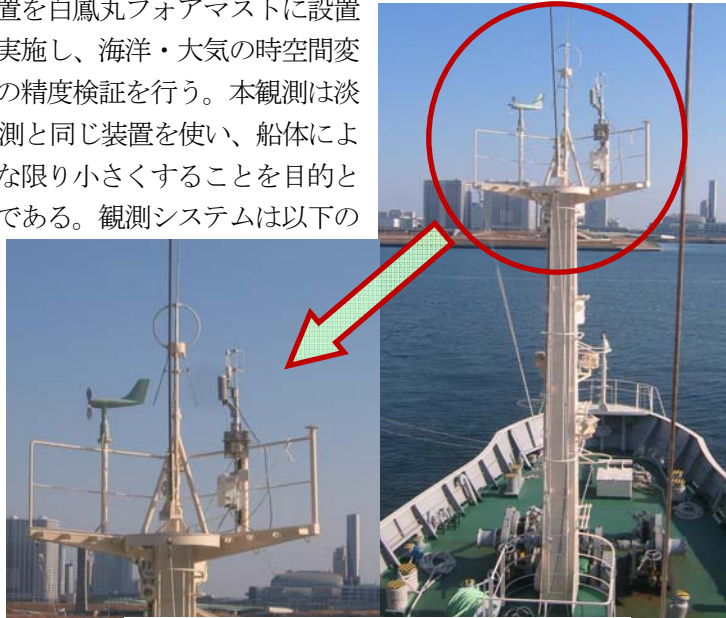
図2. 可搬型乱流フラックス観測装置
