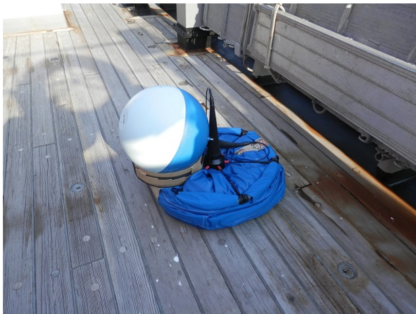
写真 3：投入前にデッキ上で鎮座している漂流ブイ。
