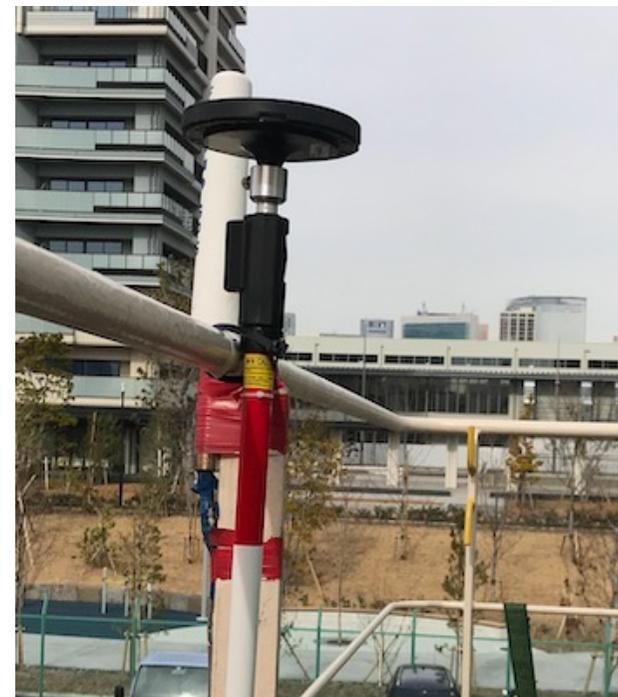
図1:GNSSアンテナ
