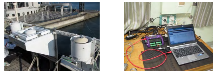
図1 日射計および赤外放射計（左）とデータロガー（右）
