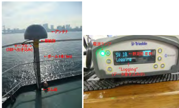
写真：観測機器状況(左：アンテナ、右：ロガー)
