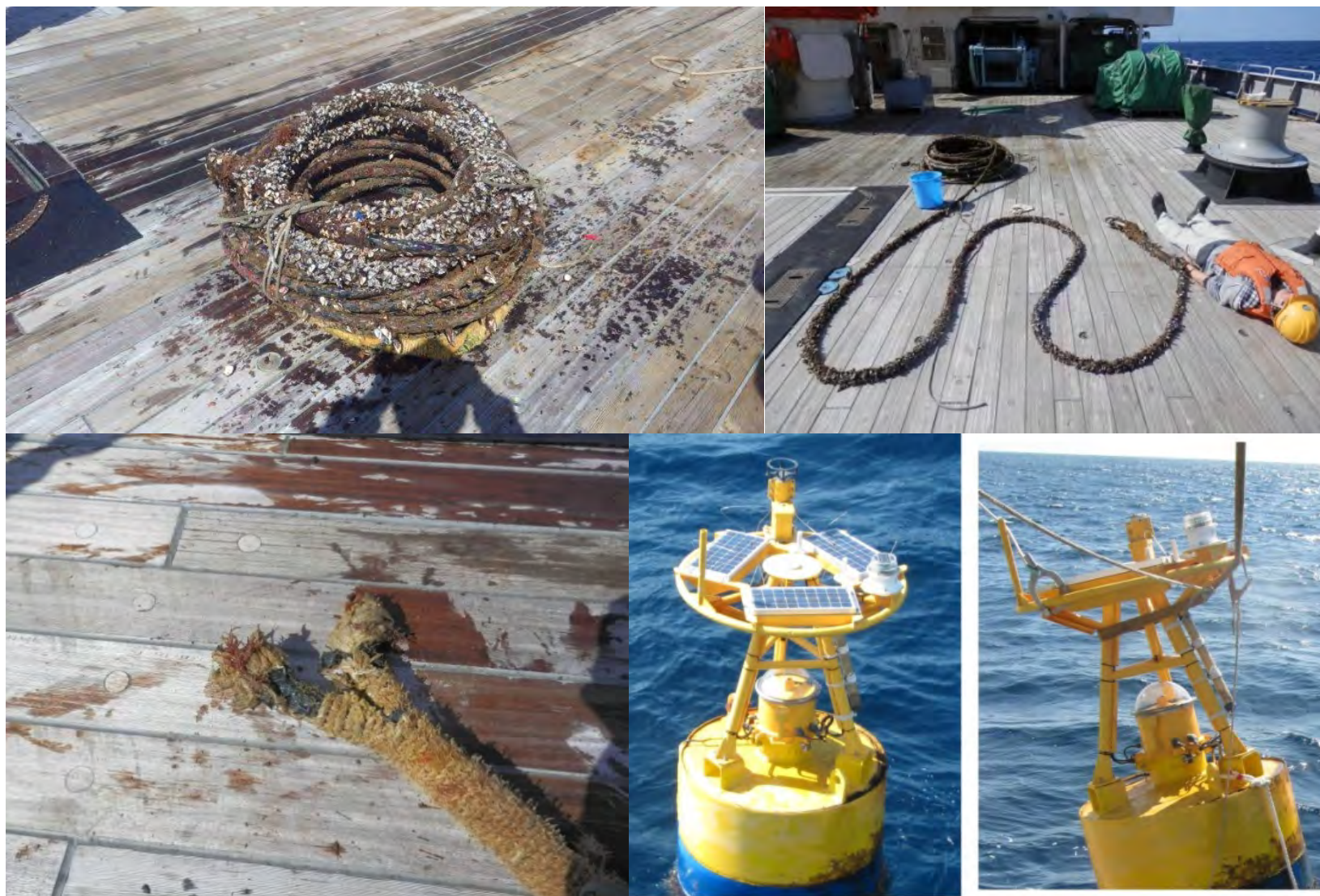
図4：観測ブイ画像：（左上）回収後のロープ；（右上）生物付着はロープ上部7m程度； （左下）破断したアイ、おそらくスイベル接続部；（右下）漂流中と回収時の波浪観測ブイ
