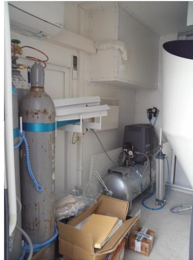
写真 9-2: コンテナ入り口から見た内部の左半分。コンテナの奥の白い筒はゾンデ放球用のランチャー。奥の左側にあるのはランチャーを動かすためのコンプレッサーとタンク。左側面手前はヘリウムガスのボンベが青いバンドでラックに固定されている。
