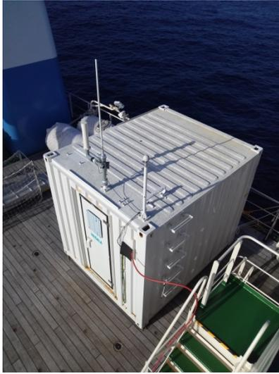
写真 9-1: 新青丸の船橋甲板左舷側に搭載されたゾンデ放球コンテナの外観。上面に GPS アンテナと UHF アンテナ、右側面に梯子が設置されている。正面入り口の扉の右上側にある小さな導入口から、船の電源とアンテナからのケーブルがコンテナ内部に引き込まれている。
