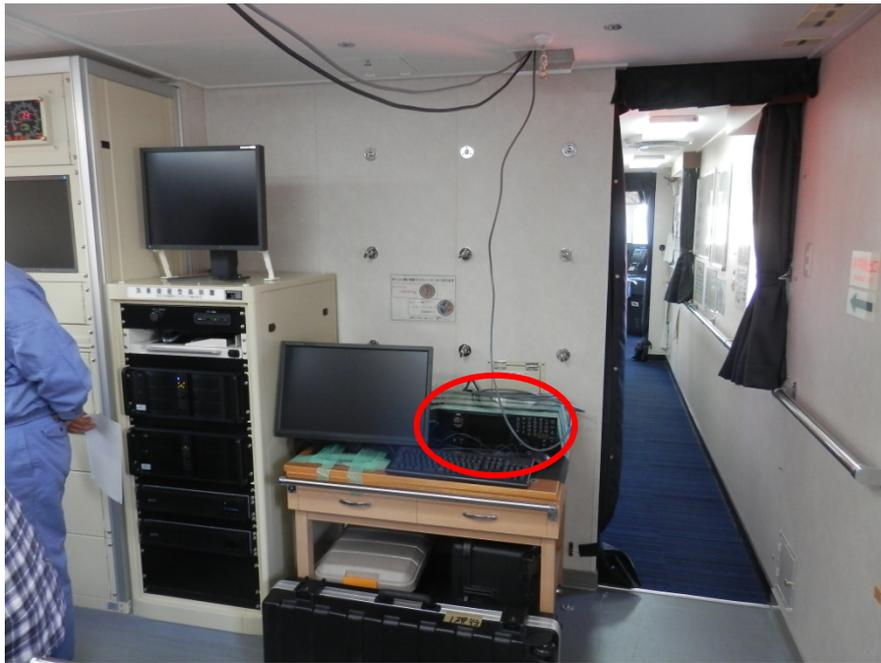
写真 6-2. 第 1 研究室に設置した短波レーダ受信機 (赤丸で囲んだ部分)。
