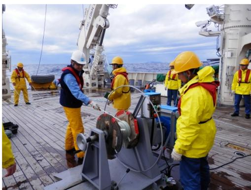
写真 12-5 : 回収したロープの巻き取り
