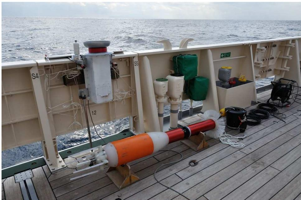
ターボマップの外観。左からターボマップ（左端がセンサ部）、ターボマップのフランジ部（右端）を繋ぐ100mロープ（白）、錘つきバケツ（ロープ収納用）、バケツについた切り離し装置から伸びる信号ケーブル。舷に取り付けてあるのは可搬型キャプスターン。
