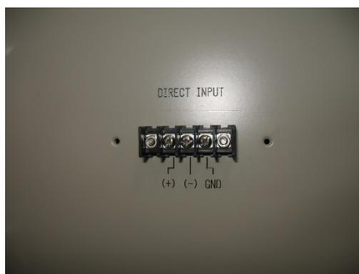
写真 12-6: 船底トランスデューサー入力端子 (1研)
