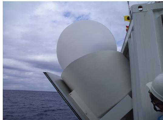
写真 9-4: コンテナの後面へランチャーを傾け、船の左舷方向に向けてゾンデを放球する様子。
