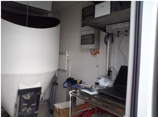
写真 9-3: コンテナ入り口から見た内部の右半分。図の左はランチャー。右側面のテーブルに置かれたノート PC (サウンディングワークステーション) を用いて、データの入出力や描画、保存を行う。その左後ろに置かれた白い装置がグラウンドチェックセット GC25 で、ワークステーションに接続されている。テーブルの上の棚に設置された白い箱はゾンデから受信したデータを処理するサブシステムで、ワークステーションと外部のアンテナに接続されている。
